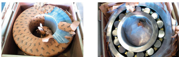
Ambas imágenes son de productos falsificados. Envoltura incorrecta y sin marcas.
