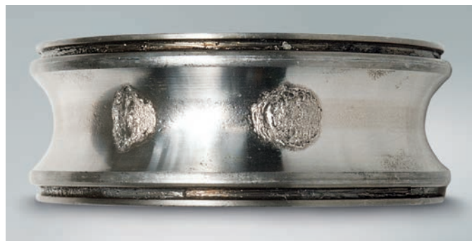
Typischer Ermüdungsschaden: Kleine, flache Teilchen lösen sich vom Lagerwerkstoff (Pittingbildung).
