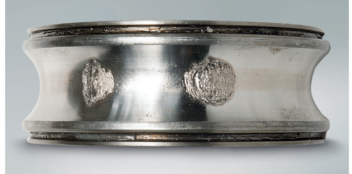
Tipik yorulma işaretleri: rulman malzemesinde küçük ve yassı pullanmanın ayrışması (pullanma/kavlanma)
