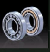
円筒状のころと軌道とが線接触をした形状の軸受。主としてラジアル負荷能力が大きく、また高速回転に適している。鋼板打抜き保持器のEWシリーズおよび銅合金一体形もみ抜き保持器のEMシリーズは、優れた機能性と長寿命を実現した高負荷容量標準軸受である。
