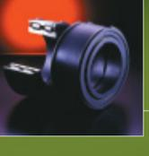
クレーンロープシーブ用として特別に設計された薄肉・幅広い総ころ形複列円筒ころ軸受で、一般産業機械の低速・高荷重の用途にも多く使われている。非分離形軸受で大きな衝撃荷重やモーメント荷重にも耐え、シーブ用として十分なスラスト負荷容量をもっている。
