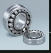
2列の軌道を持つ内輪と球面の軌道を持つ外輪との間に、たる形を組込んだ軸受。ラジアル荷重とアキシャル荷重の両方向で負荷することができる。特にラジアル負荷能力が大きく、重荷重、衝撃荷重のかかる用途に適している。HPS自動調心ころ軸受シリーズは、従来よりも長寿命および高許容回転数を実現した高機能標準軸受である。
