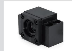
ボールねじの支持軸受ユニット「クリーン環境用サポートユニット」を用意しています。クリーングリースを封入しており、低発塵に優れています。ハウジングには低温クロムめっき、また小部品にはステンレス製を採用しています。ロックナット等の必要部品も付属していますので、設計・組立の簡略化に貢献します。
