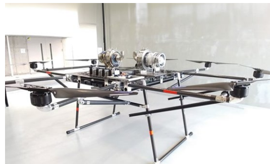
ガスタービン発電機を搭載した高ペイロード緊急物資輸送用ドローン (提供:エアロディベロップジャパン株式会社)
