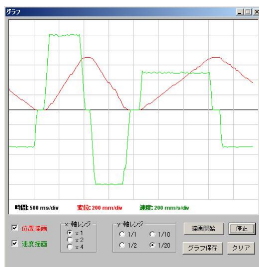
図 8.21 グラフ表示例 (速度 1000mm/s および 500mm/s, 加速度 9800mm/s 2 , 700mm 往復)
