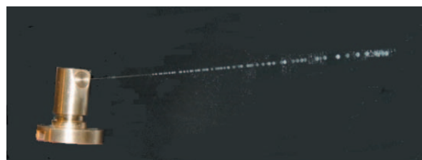
図5 ノズルからの潤滑油の噴射 (0.003cm 3 ) Fig. 5 Droplets of oil discharged from nozzle
