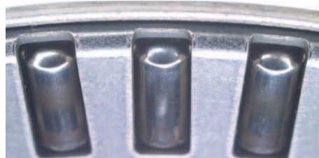
写真2 接触改善品 試験終了後外観写真 Photo 2 Improved contact-type cage
