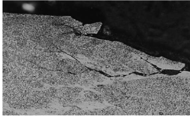
写真1 はくり部直下白色組織変化 Photo 1 White structure flaking
