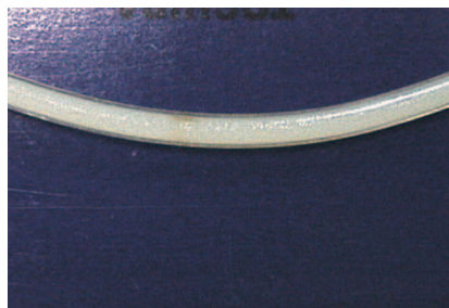
写真2 グリース加圧試験中のチューブ内グリースの様子 Photo 2 Comparison of grease under high-pressure testing
