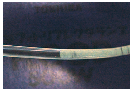
写真2 グリース加圧試験中のチューブ内グリースの様子 Photo 2 Comparison of grease under high-pressure testing
