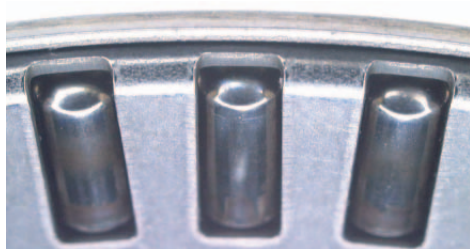
写真3 LGスラストニードル軸受 試験終了後外観
