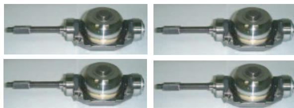
図2 トロイダルCVTのバリエータ主要構成部品 Fig. 2 Main parts of variator for current half-toroidal CVT
