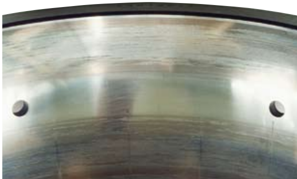
写真1 スミアリング発生例 2) Photo 1 Example of smearing
