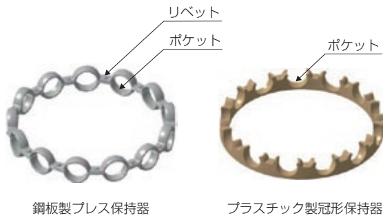
図3 保持器の種類 Fig. 3 Cages for deep groove ball bearings
