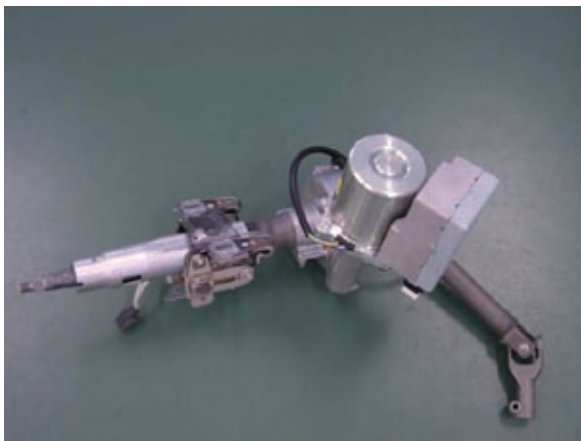
写真 1 直進走行感（オンセンター感）向上機能付き電動パワーステアリング
