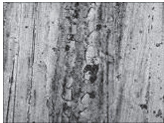
写真 2 冷媒環境試験品のピーリング損傷部 Photo 2 Peeling failure after refrigerant environment testing
