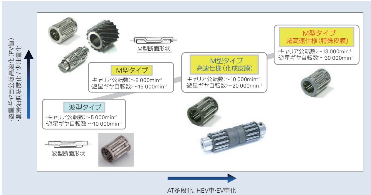
図4 プラネタリ用ケージ&ローラ 開発の歴史 Fig. 4 Development history of the planetary cage & roller
