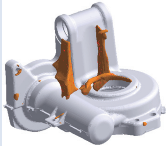
図5 鑄造シミュレーションによる鑄巣分布(従来品) Fig. 5 Casting simulation of porosity distribution (conventional product)
