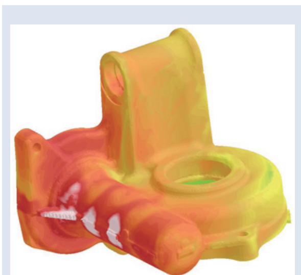
図 11 充填完了時の温度分布
