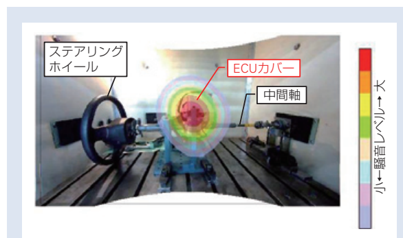
図 6 音源探査結果例(ラトル音) Fig. 6 Result of noise source identification (rattle noise)
