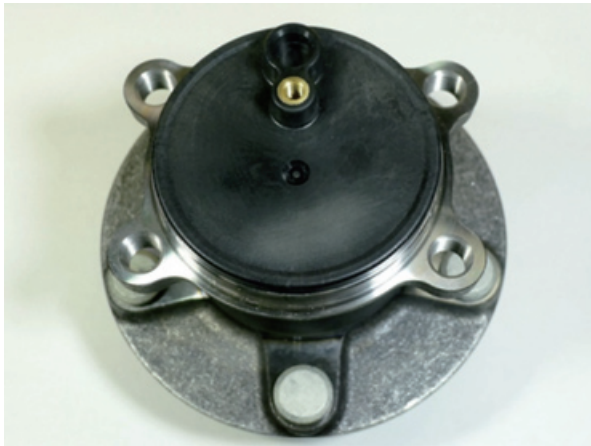
写真1 密封樹脂センサキャップ付きハブユニット軸受 Photo 1 Hub unit bearing sealed by plastic sensor cap
