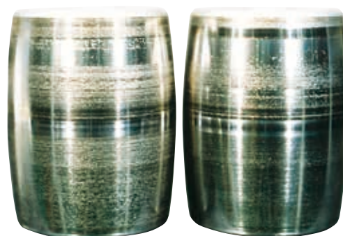
図7 スミアリング損傷(転動面) Fig. 7 Smearing Damage (Rolling Surface of Rollers)
