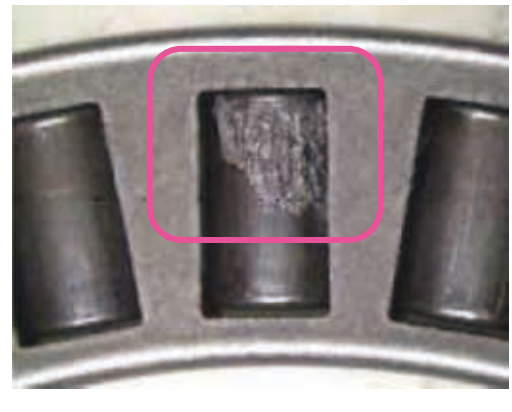
図5 傾斜下のスラストニードル軸受のエッジロード剥離
