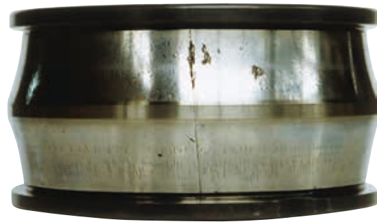
図6 内輪割れ(自動調心ころ軸受) Fig. 6 Inner Ring Fracture (Spherical Roller Bearing)
