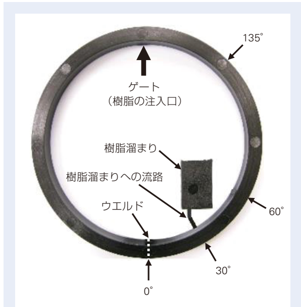
図 1 円環試験片 Fig. 1 Ring-shaped test piece
