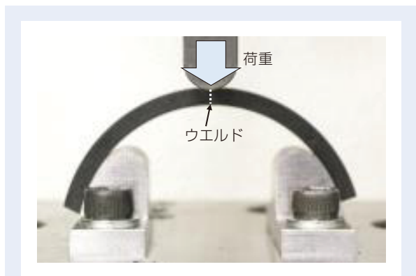
図 2 円環試験片の強度測定のための実験装置 Fig. 2 Apparatus for strength measurement of test piece
