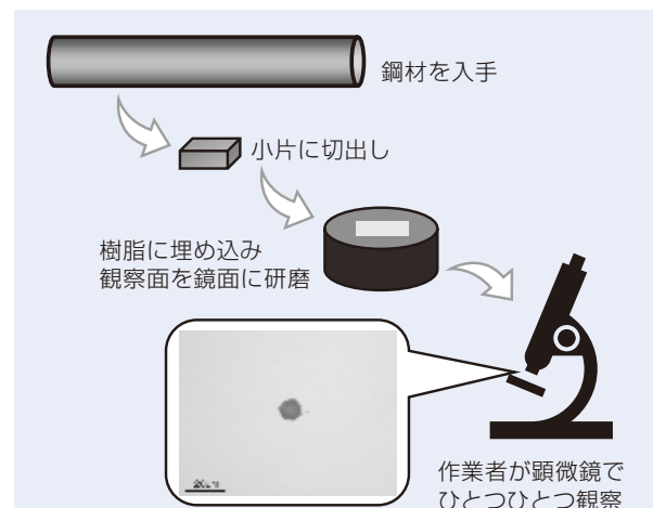
図 3 従来の材料清浄度評価法の例
