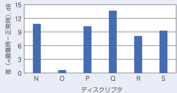
図 8 リニアガイドのはく離ディスクリプタ評価結果 Fig. 8 Evaluation of spalling descriptors for linear guides
