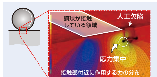
図6 欠陥まわりの力のシミュレーション解析
