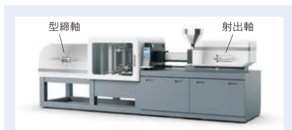
図 1 電動射出成形機における高負荷駆動用ボールねじの採用部位
