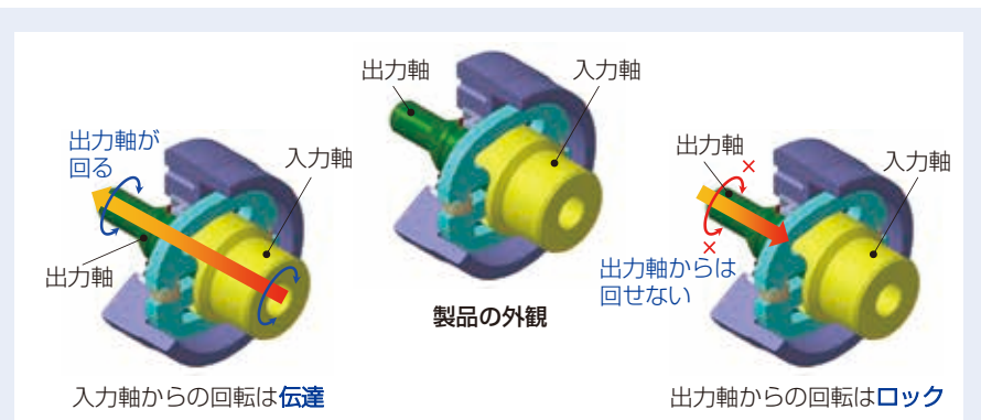
図1 ロッキングクラッチの機能 Fig. 1 Functionality of Locking Clutch
