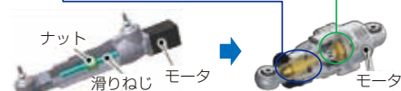
従来後輪操舵アクチュエータ 高効率後輪操舵アクチュエータ
