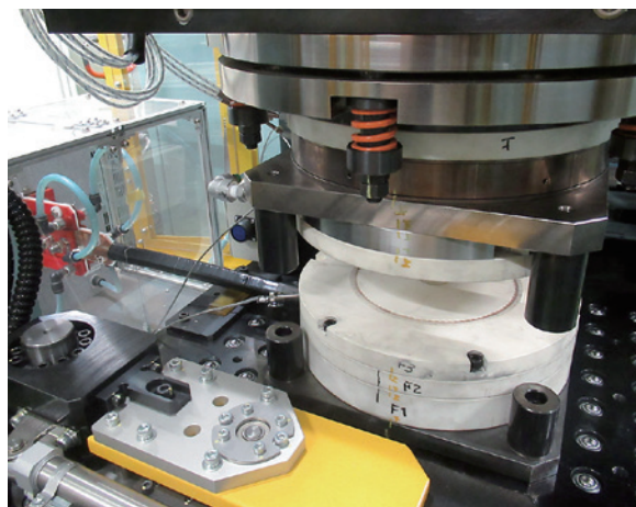
高周波式 摩擦材接着設備
